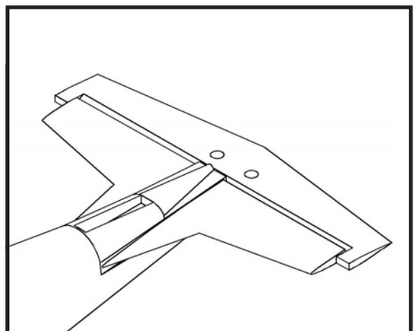
**INSTALLING THE VERITICAL STABILIZER.**
