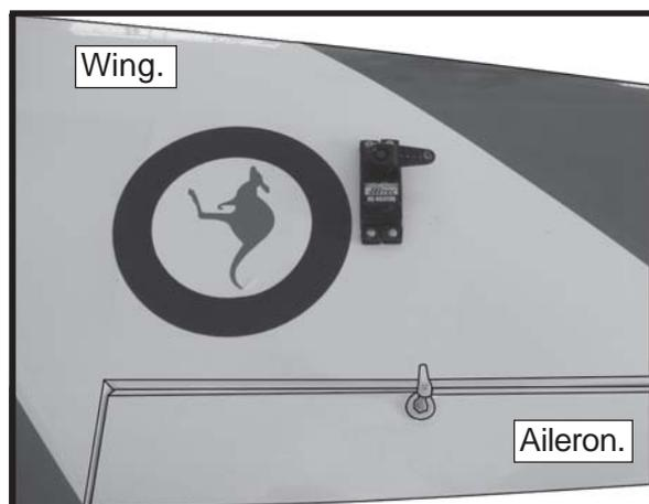
**AILERON PUSHROD HORN INSTALLATION**
